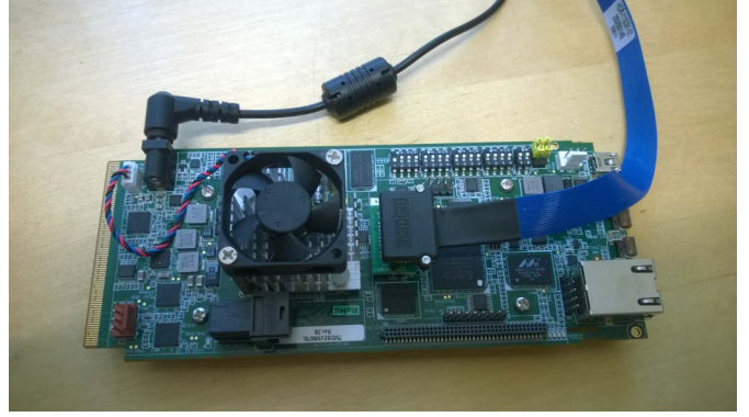
Fig. 1. DSP EVM TMDXEVM6678L
