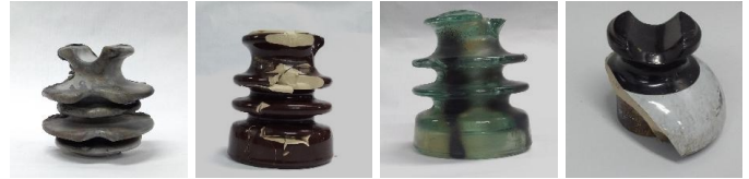
(a) Deformed (b) Fractured (c) Stained (d) Broken
